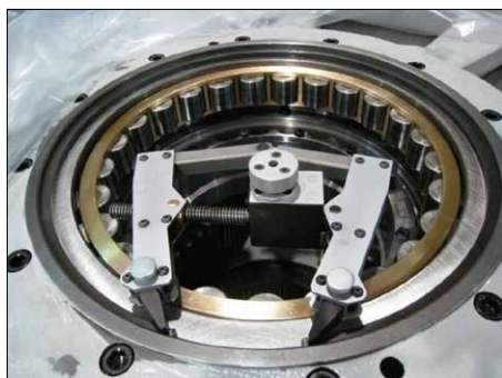
ett verktøy for store innvendige- og utvendige låseringer
